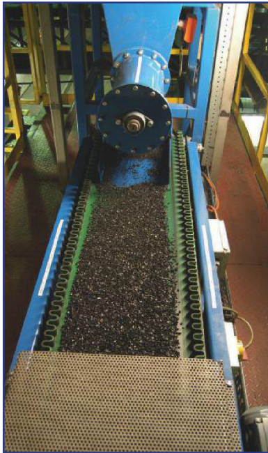
De doseerschroef en de trilgoot voeden de weegband gelijkmatig
